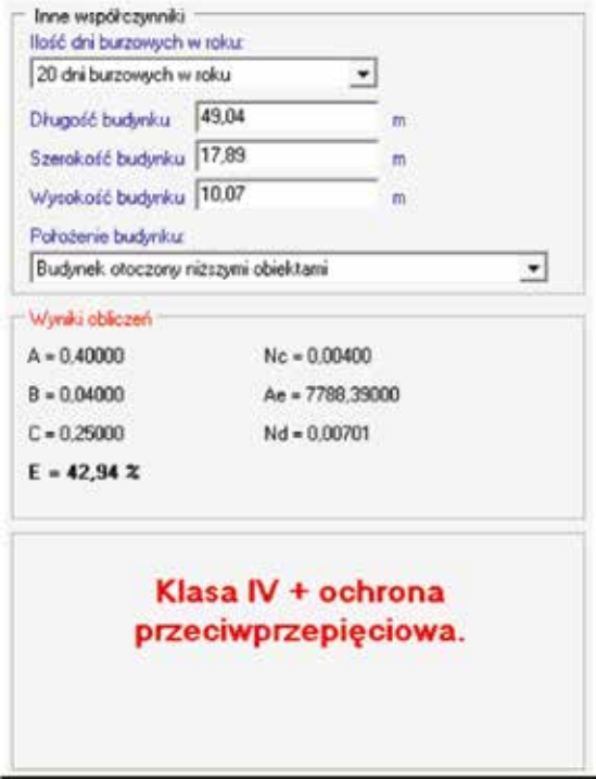
Rys. 11. Wyniki obliczeń instalacji odgromowej
