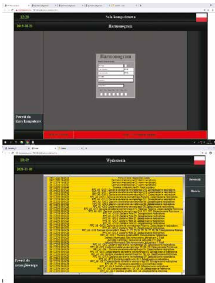
Rys. 19. Konfiguracja harmonogramów oświetlenia (a) i odczyt alarmów (b) zrealizowane na bazie WAGO e!Cockpit
