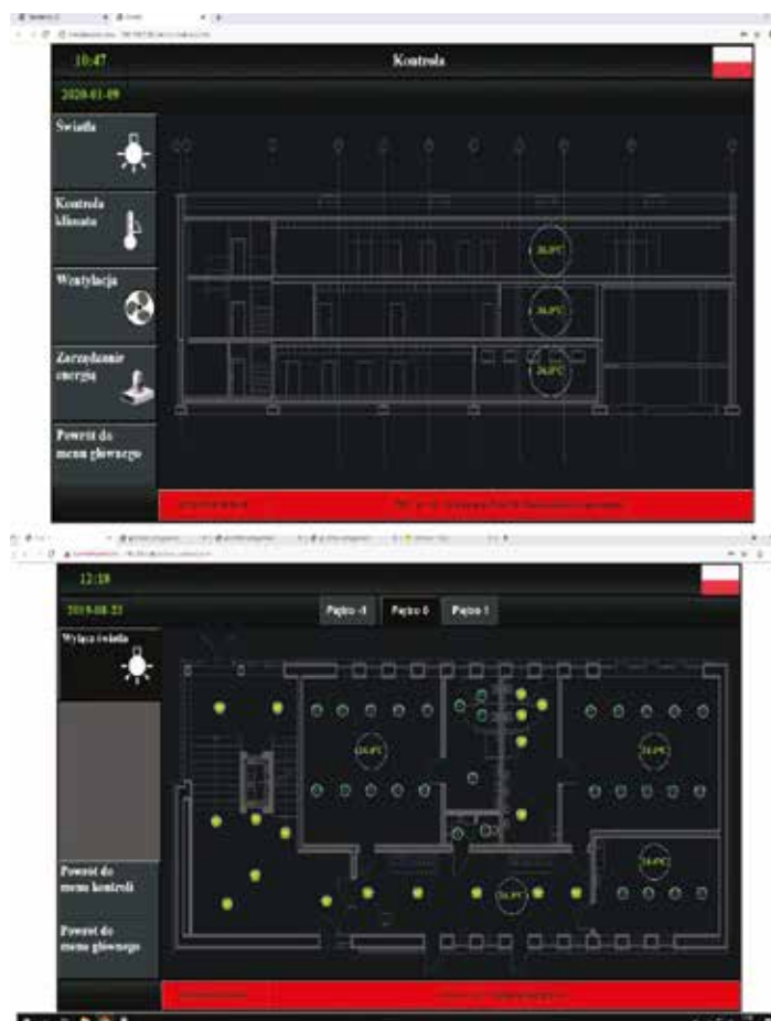
Rys. 17. Sterowanie oświetleniem zrealizowane na bazie WAGO e!Cockpit
