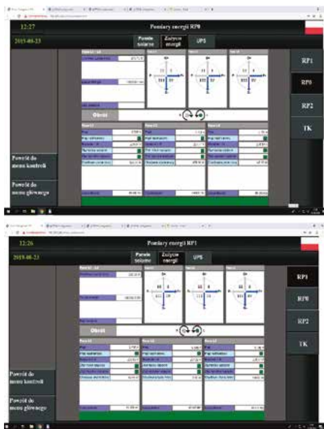
Rys. 9. Pomiar energii elektrycznej rozdzielnic RP0 i RP1 w systemie BMS
