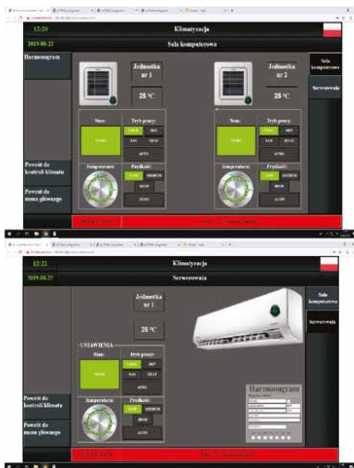
Rys. 18. Sterowanie klimatyzacją zrealizowane na bazie WAGO e!Cockpit
