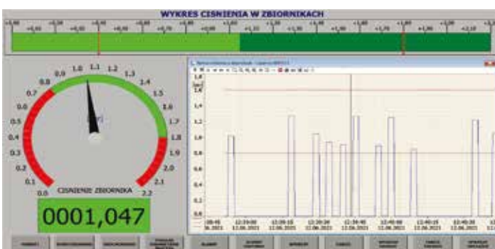
Rys. 14. Monitorowanie pomiaru ciśnienia na stanowisku kontrolnym
