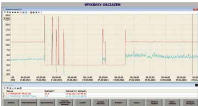
Rys. 13. Monitorowanie parametrów falowników silników napędowych
