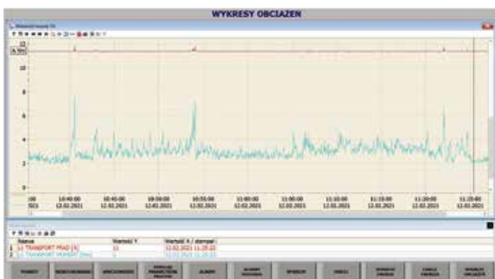
Rys. 20. Monitorowanie prądu i momentu obciążenia silników napędów łańcucha
