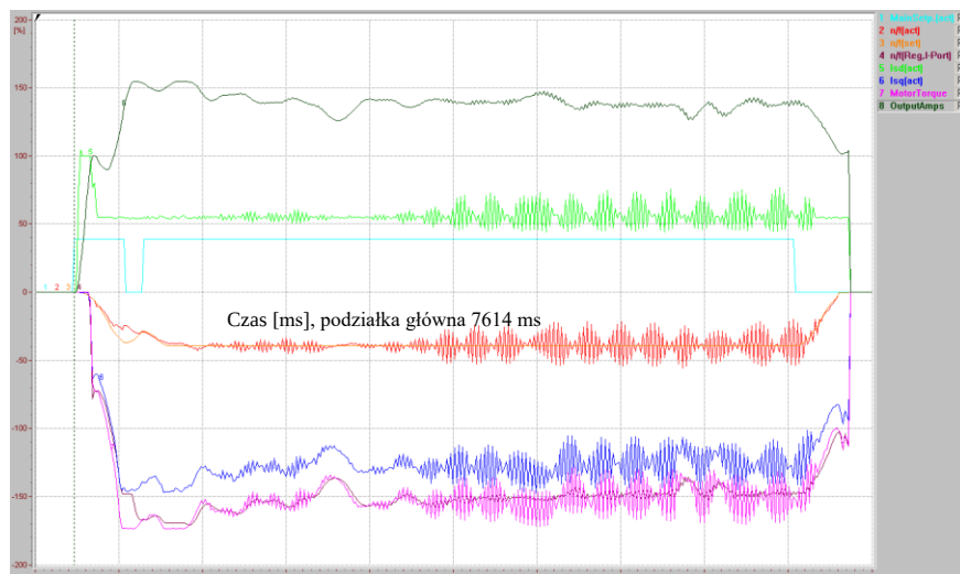
Rys. 14. Przebiegi ruchowe odnoszące się do wektorowego algorytmu sterowania przonośnikiem PGOT - przonośnik zdawczy – obrót nadwozia D2U1 – grupowy układ sterowania odnoszący się do algorytmu wektorowego [opracowanie własne na podstawie [1]]
