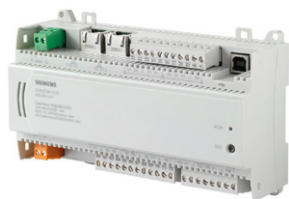
Sterownik kompaktowy PLC 24 V AC, 8 wyjść triak, 2xDI, 4xUI, 4xAO, BACnet/IP, KNX/PL-Link DXR2.E18-102A
