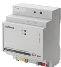
Gateway IP KNX/BACnet, kontroler aplikacji BACnet jako brama między KNX TP i BACnet IP, do 250 obiektów BACnet, konfiguracja za pomocą ETS 5WG1143-1AB01
