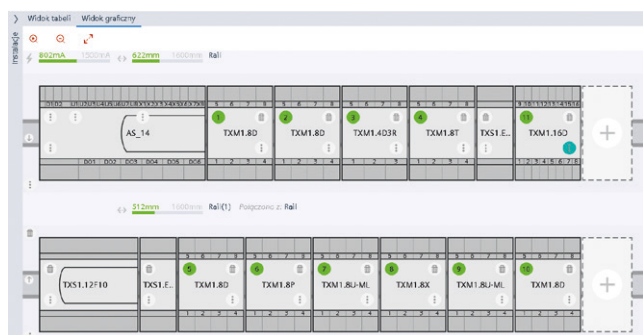
Rys. 10. Tworzenie konfiguracji hardware sterownika systemu budynkowego w oprogramowaniu ABT Site firmy Siemens [18]
