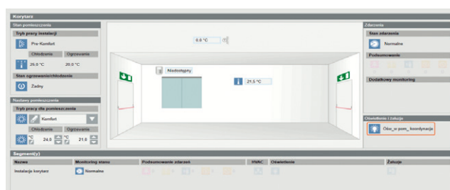
↑ Rys. 8. Wizualizacja zaimplementowanego systemu BACS/BMS automatyki budynkowej na bazie Designo CC firmy Siemens, na przykładzie Inteligentnego Piętra Katedry Aparatów Elektrycznych PŁ [16, 17]
