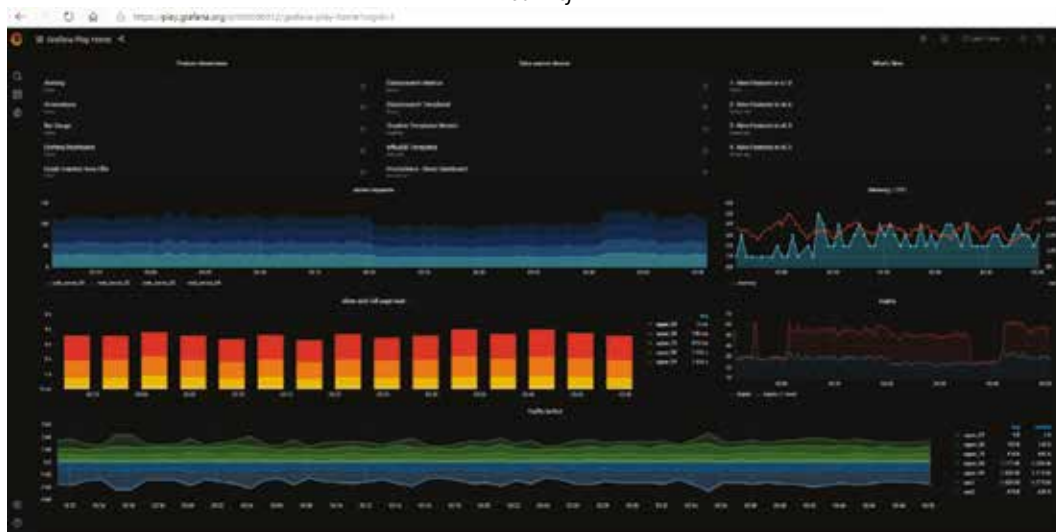
Rys. 11. Wizualizacja pracy systemu BACS za pomocą Grafana [7]
