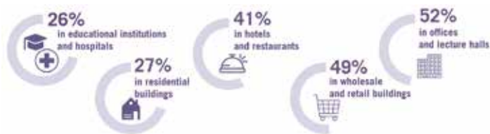
Rys. 7. Procentowa możliwość redukcji zużycia energii cieplnej i elektrycznej przy zastosowaniu systemów BACS [5]
