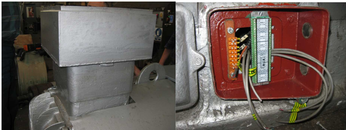
Rys. 3 a) Nadbudowana skrzynka stojana silnika T1; b) Listwa czujników T1
